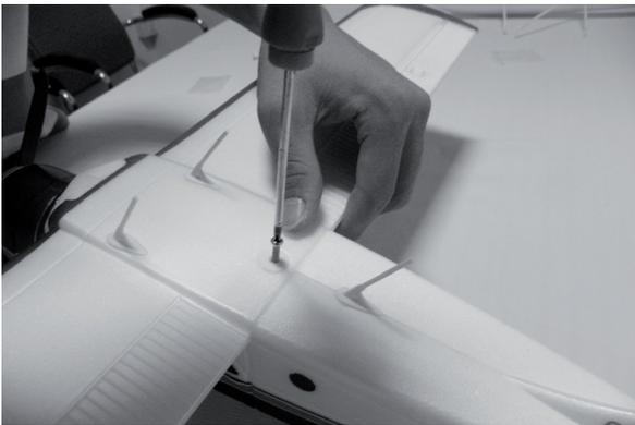
Die Tragfläche wird mittels der im Lieferumfang enthaltenen Schraube fest mit dem Rumpf verbunden. Für zusätzliche Stabilität sorgen die Tragflächenstreben aus Kunststoff.
