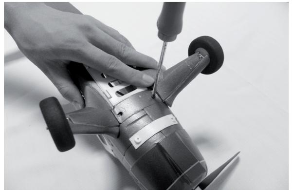
Setzen Sie das Hauptfahrwerk unter Zuhilfenahme des im Lieferumfang enthaltenen Klebstoffs zusammen. Dann wird das Hauptfahrwerk mit den beiliegenden Schrauben am Rumpf befestigt.
